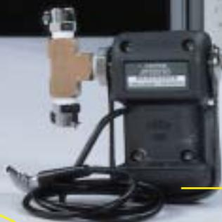
11、700系列压力模块(0~2.5kPa, 0~70MPa)可以进行压力变送器以及相关仪器的校准。(仅限5520A)
