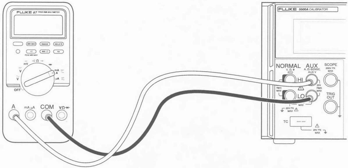
(图 4-17, 测试 80 系列仪表大电流功能的电缆接法)
